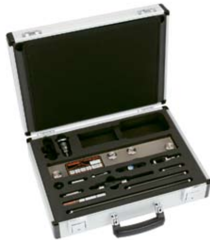
Комплект QC20-W ballbar с калибратором Zerodur®
